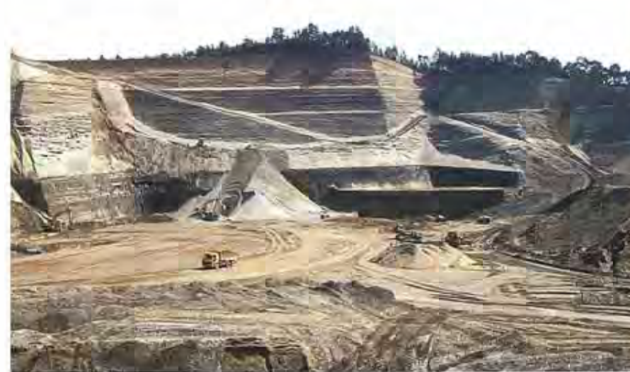
硬質な粒子からなる千葉の山砂。コンクリートや埋め立てに適した砂質をもちます。
