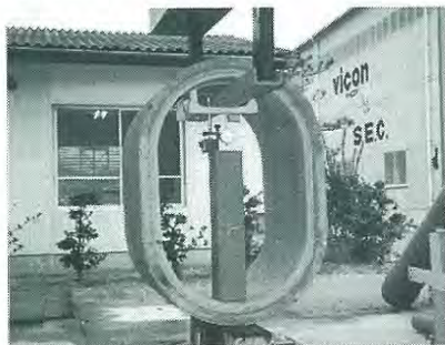
水平方向荷重試験
